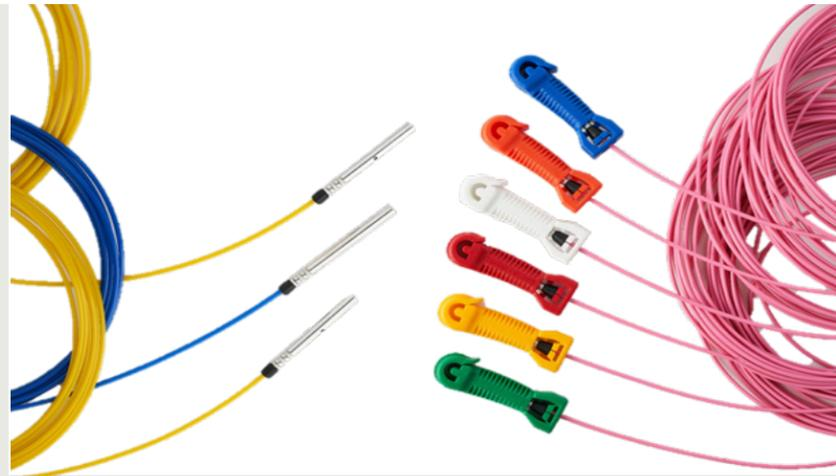
하이넬 플러스는 저에너지, 저폭속(2,200m/s)의 쇼크튜브(Shock Tube)를 화염전달 기구로 사용하는 비전기식 뇌관으로 폭약을 기폭시키기 위해 사용되는 화공품입니다. 초시체계 및 정밀도가 하이데토 플러스와 비슷하며 진동이 적고 파쇄도가 우수합니다. 특히, DHD(Downhole Delay Detonator)와 SDD(Surface Delay Detonator)를 사용할 경우에는 지연발파 공수를 무한대로 할 수 있는 장점이 있습니다. 하이넬 플러스로 구성할 수 있는 발파시스템에는 MS/LP와 도폭선, MS/LP와 Bunch Connector, DHD와 SDD 등의 다양한 방법이 있으며, 현장 여건에 따라서 선택적으로 사용이 가능합니다.
